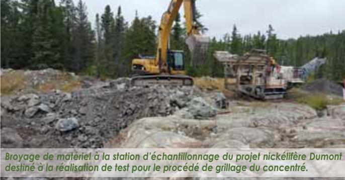
Broyage de matériel à la station d'échantillonnage du projet nickélifère Dumont destiné à la réalisation de test pour le procédé de grillage du concentré.
